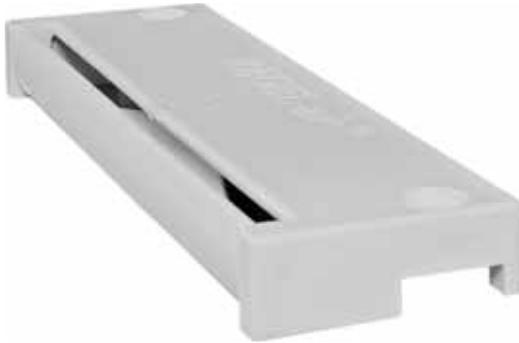
Regel-Air ist ein selbständig regelnder Fensterfalzlüfter aus Kunststoff zum paarweisen Einbau. Die automatische Volumenstrom-Begrenzung schließt die Lüfterklappen selbständig bei steigendem Winddruck. Zugerscheinungen werden dadurch vermieden.
