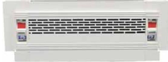
Sie funktionieren wie andere Fensterlüfter, werden aber zwischen dem Fensterrahmen und der Verglasung montiert. Die Länge des Lüfters entspricht der Breite der Verglasung und auf den Seitenendungen befinden sich Elemente, die den Luftzufluss zu regulieren erlauben. Im Angebot haben wir zwei Modelle von Lüftern: Renson THM 90 (Verglasung 24 mm stark) und RENSON AR 75 (Verglasung 36 mm stark).
